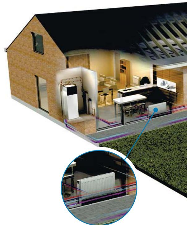
Температура воды на выходе до 65°C позволяет эксплуатировать блок с системой теплых полов, внутренними блоками для теплового насоса, а также с радиаторами.
